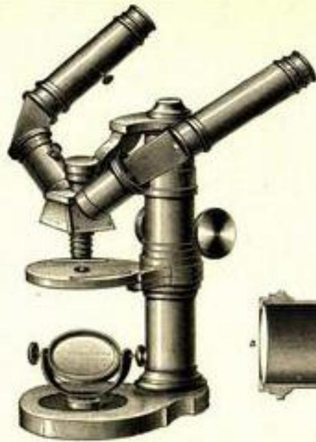
Fig. 16. Nachets Binokular-Mikroskop für zwei Beobachter.
