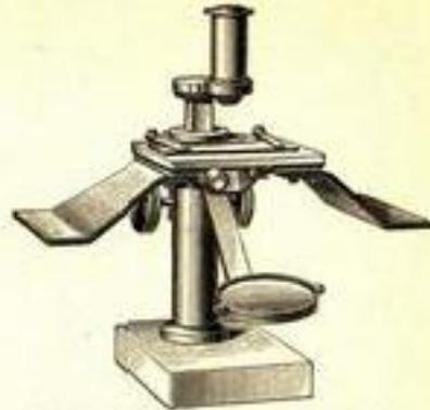
Fig. 17. Zeißches Präpariermikroskop.
