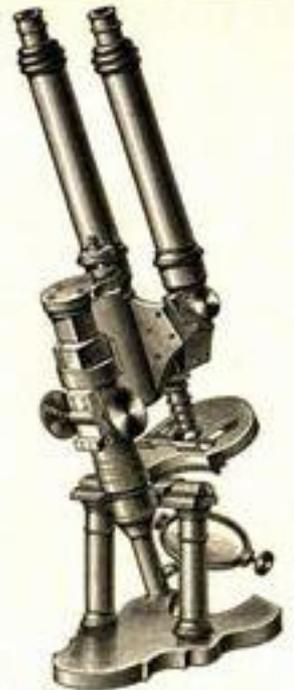
Fig. 12. Binokular-Mikroskop von Nachet.
